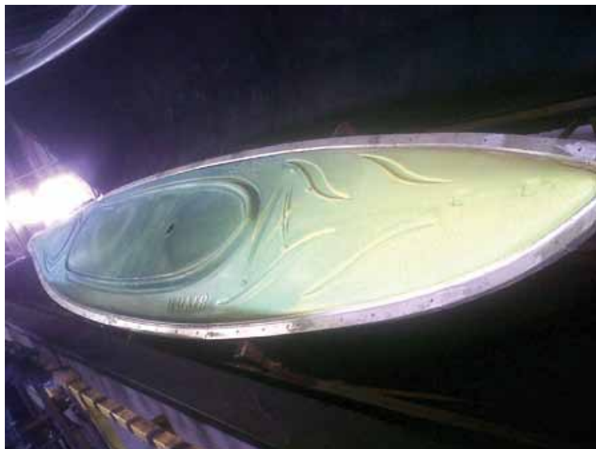
Fot 2) Etap rozformowania, wyciąganie detalu z formy.
