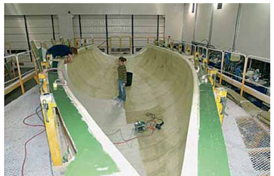
Rys. 3. Budowa kadłuba jachtu z zastosowaniem tkanin szytych
