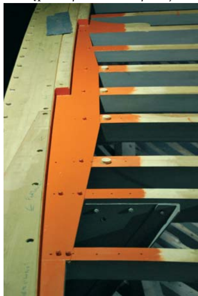
Fot. 4) Pokładniki pomalowane minią ołowianą [www.complexjacht.pl]
