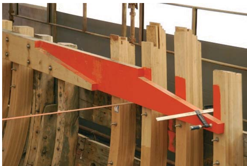
Fot. 3) Zamek łączenia wzdłużnika [www.complexyacht.pl]
