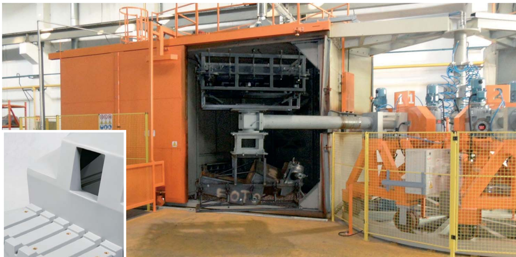
Maszyna karuzelowa do formowania rotacyjnego
