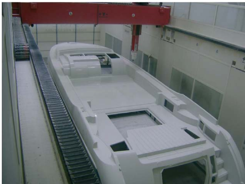
Gabaryty, jakie będzie obrabiać wysokoobrotowe centrum frezarskie włoskiej firmy Belotti są niebagatelne. Fot. Sunreef Yachts
